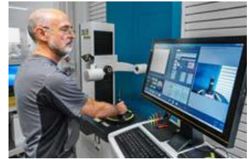
ZOLLER- takım yönetiminin grafiksel depo yüzeyi sayesinde SIM çalışanı istediği aleti hedef odaklı bir biçimde Hänel-Lift'in alet deposundan alır.
