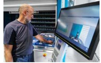
ZOLLER- takım yönetiminin grafiksel depo yüzeyi sayesinde SIM çalışanı istediği aleti hedef odaklı bir biçimde Hänel-Lift'in alet deposundan alır.
