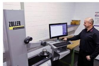
Измерение геометрии инструмента
