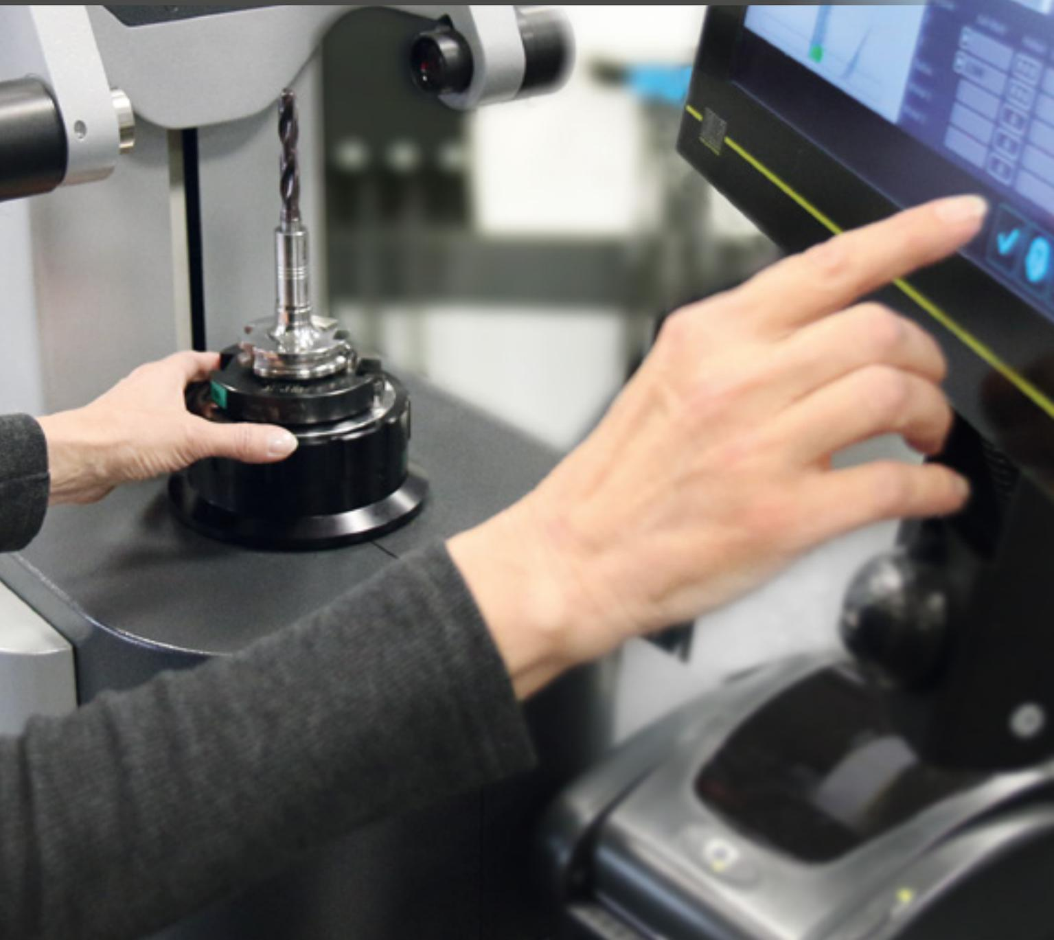
La nueva tecnología de procesamiento de imágenes »pilot 1.0« permite todas las funciones que se requieren para un ajuste y medición rápido y sencillo de herramientas estándar. Por ejemplo, la "detección automática de la forma de la cuchilla y del rango de medición", el
