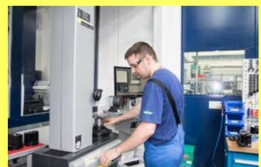
»venturion450/8« para medición y verificación de herramientas altamente complejas de VAT en Haag, Suiza
