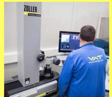
El »venturion« con procesamiento de imágenes »pilot 3.0« proporciona resultados siempre fiables con independencia del operador
