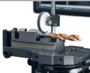
Axial 측정을 위한 회전 테이블 및 V-블록
