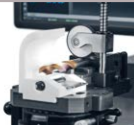
Radial 측정을 위한 시계방향 90° 위치 회전 테이블 (반사판 포함)
