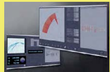
MP 28は自動的に全体、或いは 角半径を計算でき、図表で輪郭のエ ージを図られる。
