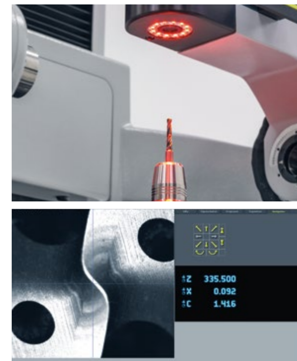
La testa dell'utensile viene visualizzata e misurata con il software di analisi utensili »metis«
