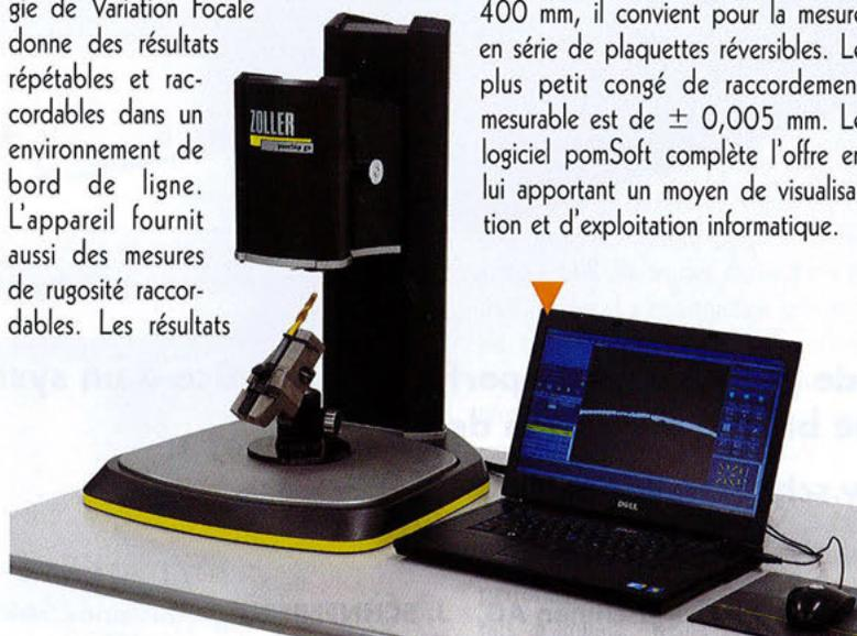
sont obtenus en 20 secondes et la surface n'a pas besoin d'une préparation spécifique. L'utilisation de ce système, déjà diffusé chez les fabricants d'outils, permet aux affûteurs de vérifier la géométrie de l'outil réaffûté et d'améliorer ainsi l'assurance qualité du produit fini.
