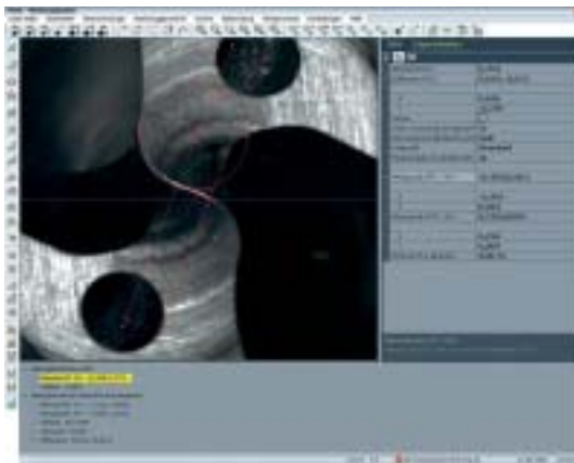
Mesure axiale à lumière épiscopique avec »metis« pour paramètres quelconques à la géométrie de front
