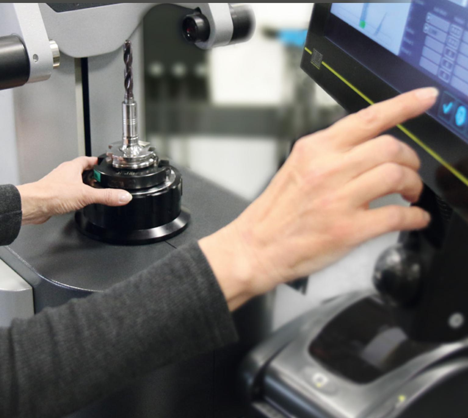
La nouvelle technologie de traitement d'images »pilot 1.0« donne accès à toutes les fonctions nécessaires pour un réglage et une mesure rapides et simples des outils standard. Par exemple "la détection automatique de la forme de l'arête et du champ de mesure", le
