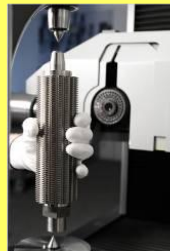
Maniement facile des fraises-mères : les outils peuvent également être serrés avec la contre-pointe dans la contre-poupée
