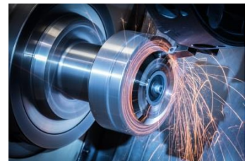
Fabrication d'un corps de base en acier hautement précis pour le revêtement diamant ultérieur. Ces éléments aussi sont mesurés avec les appareils ZOLLER lors de la production.
