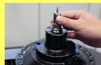
Fabrication avec des outils filigranes à partir d'une dimension de 0,29 mm
