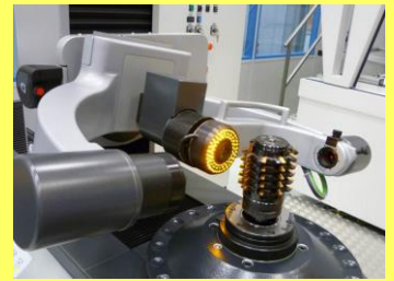
4 ejes CNC, software y procesamiento de imágenes de ZOLLER procuran procesos de medición totalmente automáticos y sin contacto.
