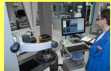
ZOLLER »hobCheck 800« en el control de calidad de SANDVIK Tooling Supply Schmalkalden.
