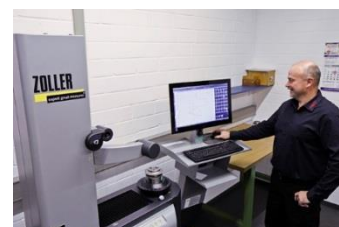
Medición de la geometría de la herramienta en el espacio de medición para la comprobación final y la protocolización.
