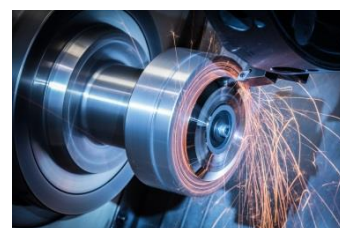
Creación de un cuerpo básico de acero de alta precisión para el revestimiento posterior de diamante. También se miden en la fabricación con los aparatos ZOLLER.
