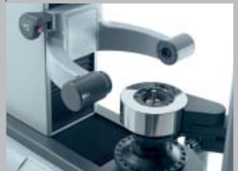
Automatische Positionierung der Schunk TRIBOS-Spanneinheit auf Schrumpfposition.
