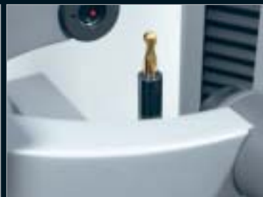
00:16 Automatisches Messen der Werkzeugschneide
