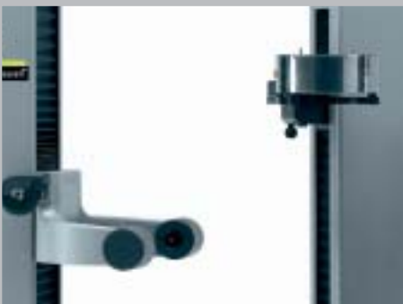
Schwenkbare Spanneinheit zum Messen und Einstellen langer Werkzeuge ohne das TRIBOS-System.
