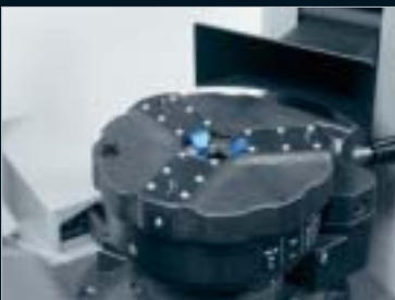
00:32 Induktionsspule fährt automatisch auf Position, Heizung beginnt
