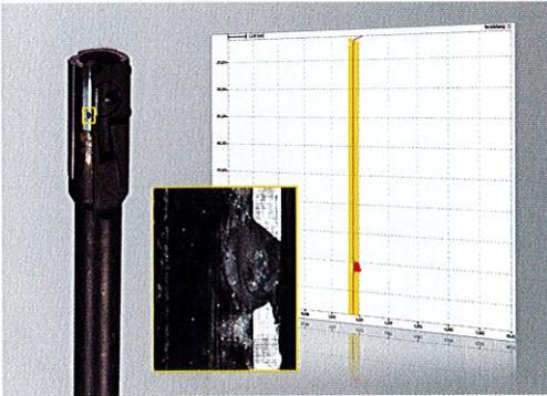
Reibahle mit Beschädigung in der Schneide, als Mikroskopbild und im Scan inklusive Soll- und Istdatenvergleich mit dem Werkzeuganalyseprogramm lasso graphisch dargestellt.
