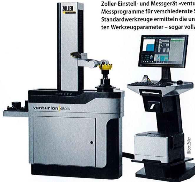
Zoller-Einstell- und Messgerät »venturion«. Über 200 Messprogramme für verschiedenste Sonder- und Standardwerkzeuge ermitteln die unterschiedlichsten Werkzeugparameter – sogar vollautomatisch.
