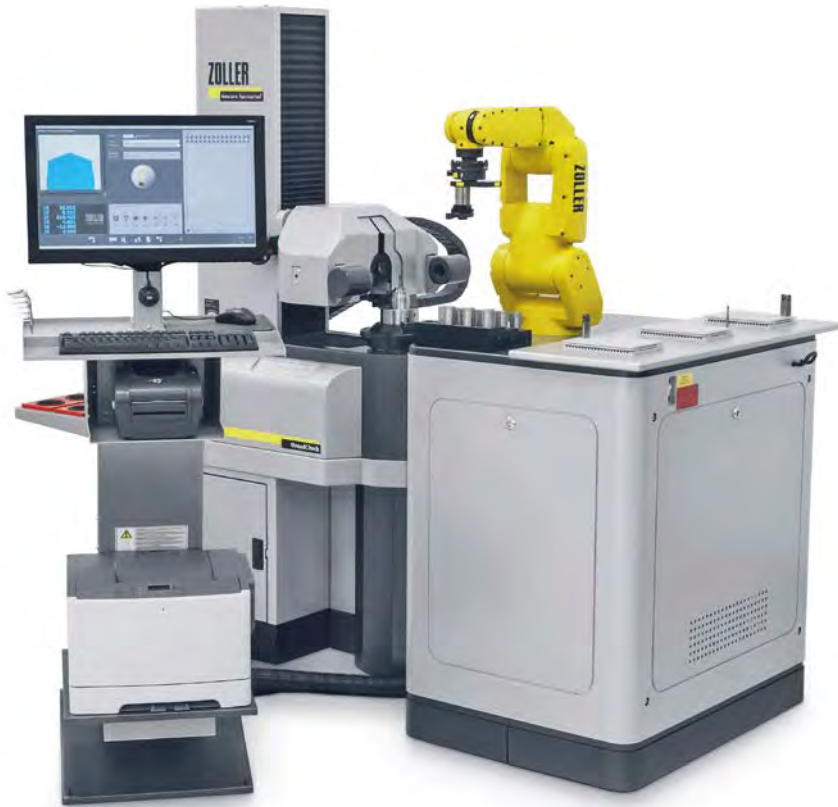
Automationslösung zur Vermessung von Gewindewerkzeugen. Reinigungs- und Beschriftungsanlagen ergänzen die Inspektion.
