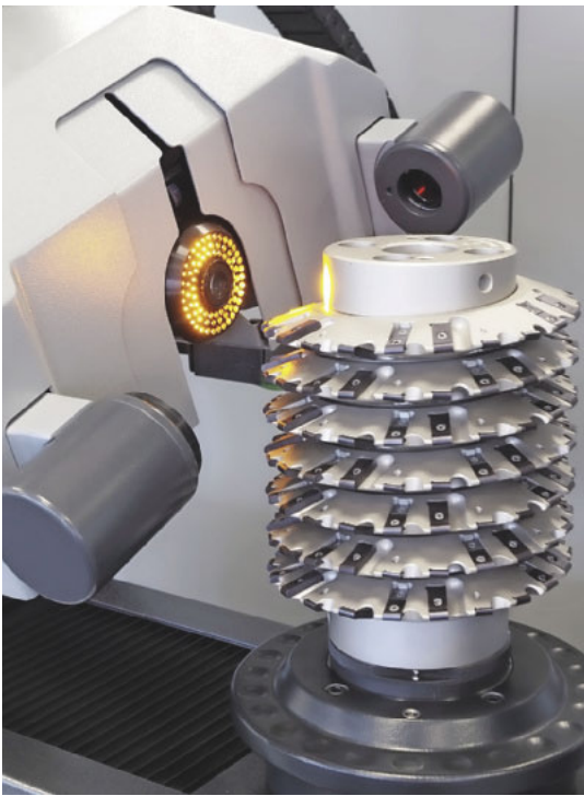
Mit der Softwarefunktion Lasso vermisst Hob-Check das Zahnprofil eines jeden einzelnen Zahnes vollautomatisch
