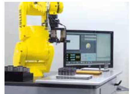
Bild 3: Einfache Bedienung: Startbutton in der Bildverarbeitung »pilot« drücken und der Automatikbetrieb startet (Werkbilder: E. Zoller GmbH & Co. KG, Pleidelsheim)
