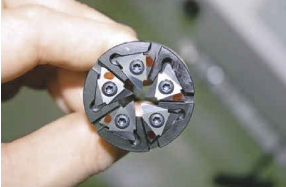
Wirbelwerkzeuge können mit dem universellen Einstell- und Messgerät Hyperion ausgerichtet werden
