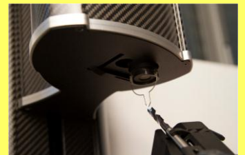
Die Positionierhilfe sichert die exakte Positionierung der Schneidkante unter den hochempfindlichen Sensoren
