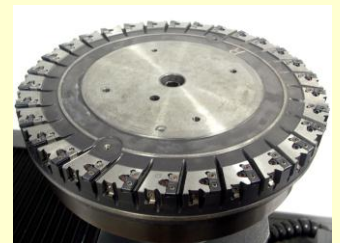
Anspruchsvolle Werkzeuge mit vielen Schneiden: Planmesserköpfe, auch Cap-Fräser genannt
