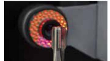
Sechs CNC-Achsen und ein schwenkbarer Optikträger garantieren die verzerrungsfreie und berührungslose Erfassung von Gewindegeometrien und verschiedenster Flankenhinterschliff-Parameter.
