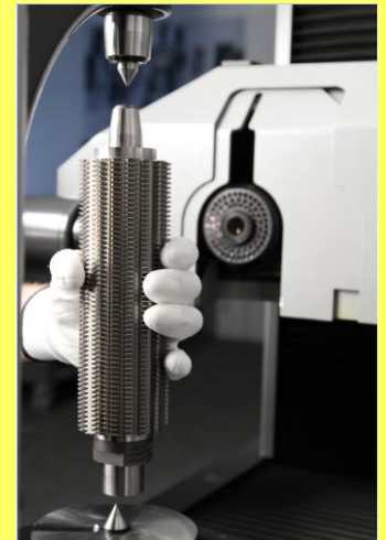
Einfache Handhabung der Wälzfräser: Die Werkzeuge können im Reitstock auch mit Gegenspitze gespannt werden
