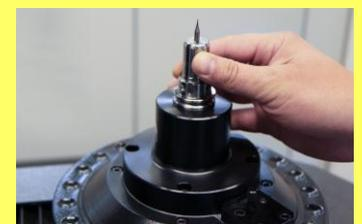
Fertigung mit filigranen Werkzeugen ab einer Größe von 0,29 mm
