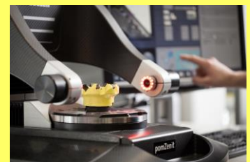
»pomZenit«: Ergonomisches Einstellen von Messerköpfen und/oder vollautomatisches Prüfen der Grundkörpers zur Endkontrolle
