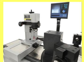
»hyperion«-Serie: auf einem einzigen Messgerät können sämtliche Werkzeugaufnahmesysteme vermessen werden
