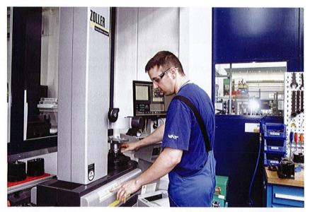
Mit dem venturion450/8 werden bei VAT komplette Werkzeugdatensätze sicher, zuverlässig und bedienerunabhängig erstellt
