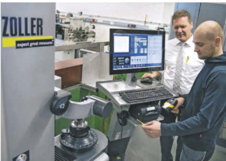
Einfache Werkzeug-Identifikation mittels QR-Code am Einstell- und Messgerät Venturion. Bild: Zoller
