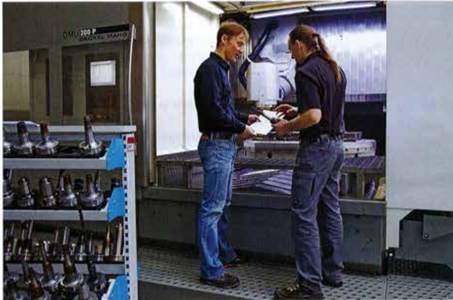
Die Standardisierung der Werkzeuge bewirkte bereits eine deutliche Reduktion der Anzahl der Werkzeugwechsel an der Maschine und damit deutlich verringerte Stillstandszeiten. Bild: Zoller
