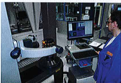
Bild 3: Zoller »hobCheck 800« in der Qualitätskontrolle bei Sandvik Tooling Supply Schmalkalden
