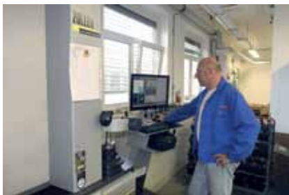
Bild 1: Die Zoller-Lösung für die GMN Paul Müller Industrie GmbH & Co. KG: Einstellgerät mit TMS Tool Management Solutions
