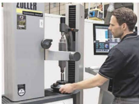
Prüfung eines Wälzfräserrohlings zwischen Spitzen am Zoller-Einstell- und Messgerät Phoenix
