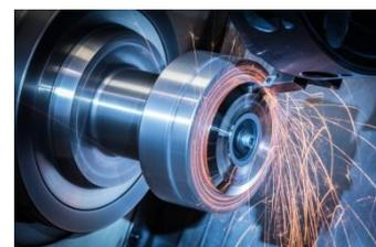
Herstellung eines hochgenauen Stahl-Grundkörpers für die spätere Diamantbeschichtung. Auch sie werden mit den ZOLLER-Geräten in der Fertigung vermessen
