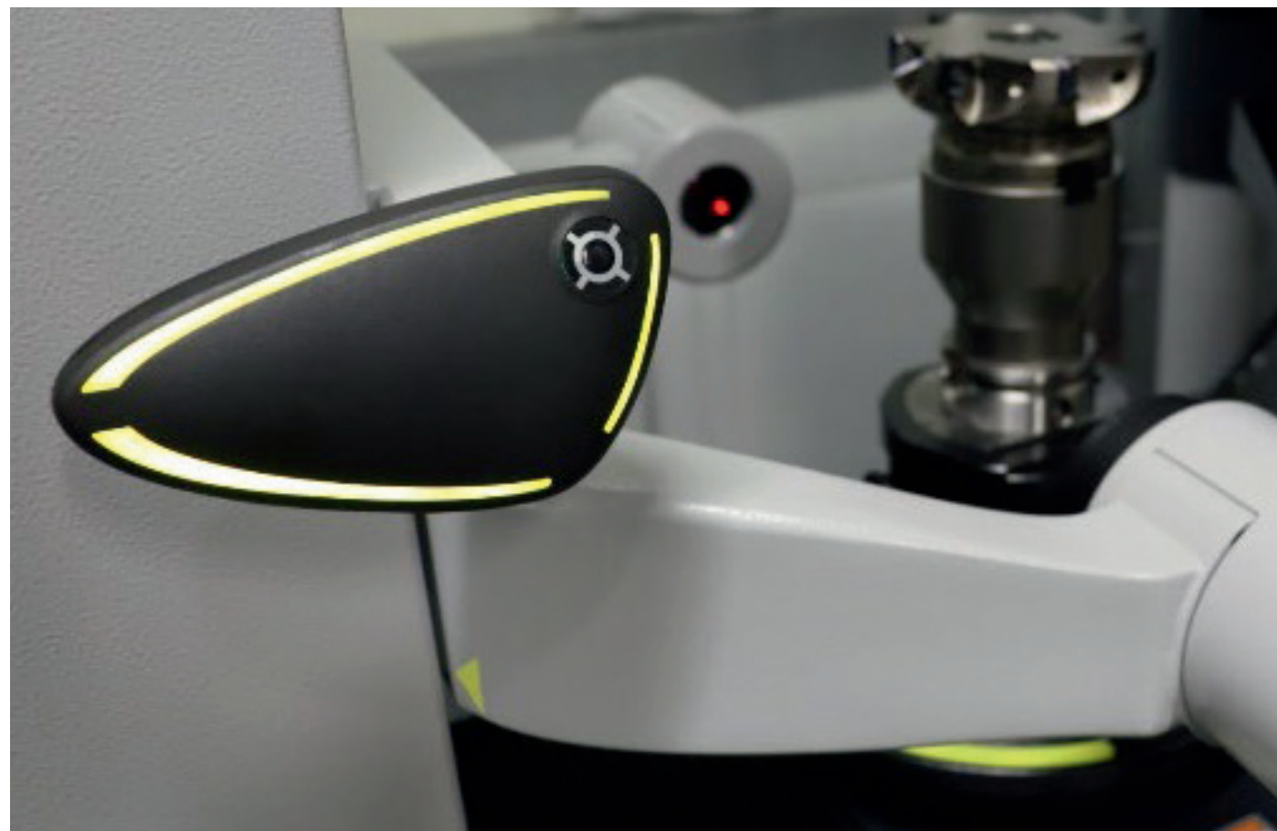
Der Einhandbediengriff »eQ« von ZOLLER unterstützt ergonomisches und schnelles Einstellen und Messen am »venturion«
