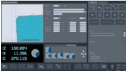
Medición manual sencilla con detección de forma de filo automática, sin instalación de datos y plantilla de valores de referencia.
