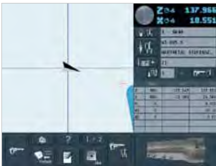
1. Навигационная система »compass« – удобная навигационная система, значительно облегчающая позиционирование осей по отношению к рецу.
