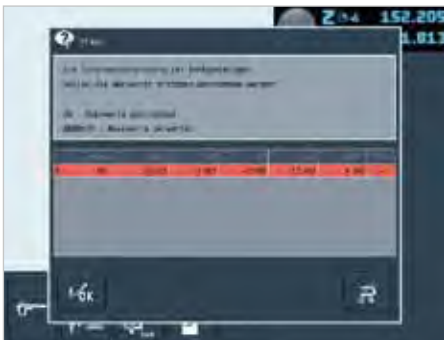
4. Проверка допусков – при превышении заданной границы допуска после измерения появляется сообщение для оператора, указывающее на превышение.
