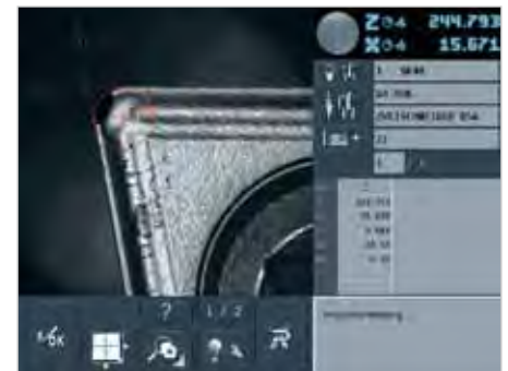
6. Диагностика резов – отколы и следы износа можно распознать на изображении в реальном времени для праворежущих инструментов.
