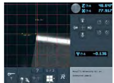
9. Устройство измерения высоты центра вращения токарных резов – с помощью дополнительной камеры отраженного света осуществляется бесконтактное измерение высоты центра и определяется смещение реза по оси Y (опционально).
