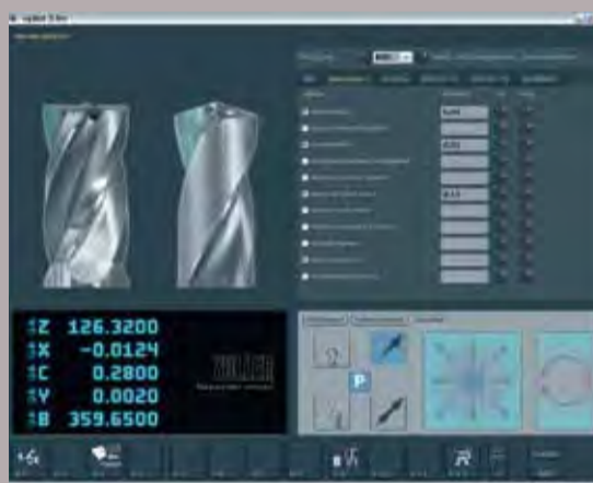
Меню выбора для измерения в пазухе зуба: пример — передний угол
