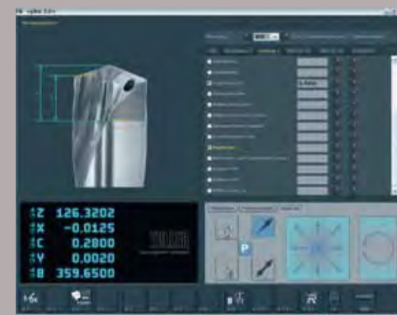
Меню выбора для измерения по окружности: пример — длина головной части
