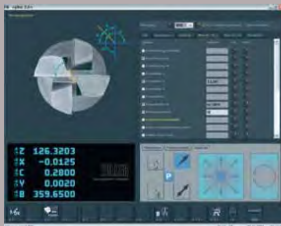
Меню выбора для измерения на торце: пример — угол наклона поперечной режущей кромки
