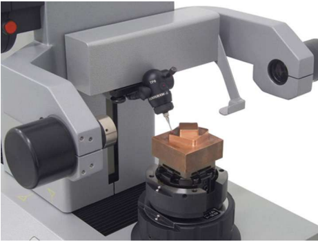
Bild 3: Der Messtaster zum Messen des Mitterversatzes in X und Y, Versatzwinkels und der Länge an Elektroden
