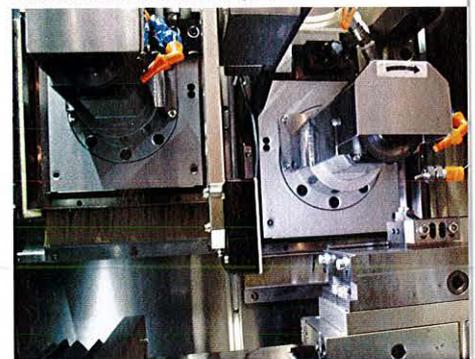
Die mit zwei Schleifspindeln ausgerüstete UPZ 210 Lill-2 ‚Double Eagle‘ erledigt die Abläufe in zusätzlichem Sprinttempo. Hier entfällt unter anderem die Notwendigkeit zum Scheibenwechsel beim Vor- und Fertigschleifen.
