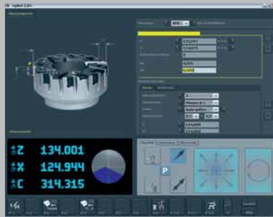
Eingabedialog »FORED«, im Beispiel Messprogramm „Fräser mit Schrupp- und Schlichtschneide“
