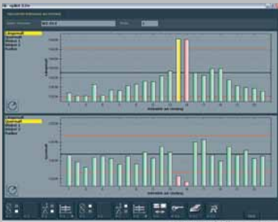
Diagramm „Größte Schneide“ mit Toleranzband und Funktion Schneidenkorrektur
