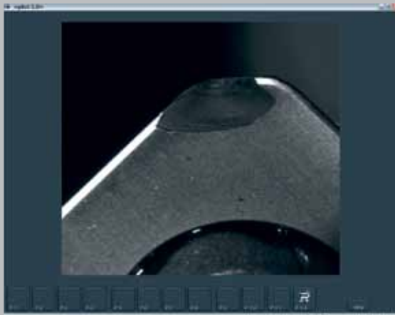
Schneideninspektion (Einzelschneide/Großbild) zur Begutachtung der Schneidenqualität
