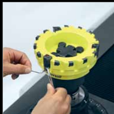
2. Bequemes Montieren und Einstellen durch optimale Arbeitshöhe und Zugänglichkeit zum Einstellmechanismus oder zur Schneide.
