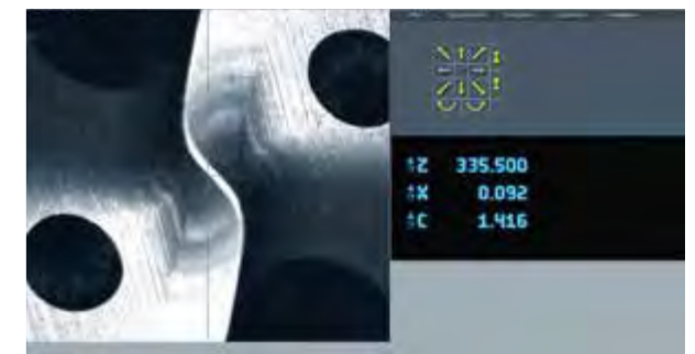
Die Stirn des Werkzeugs wird in der »metis« Werkzeuganalyse- software dargestellt und vermessen
