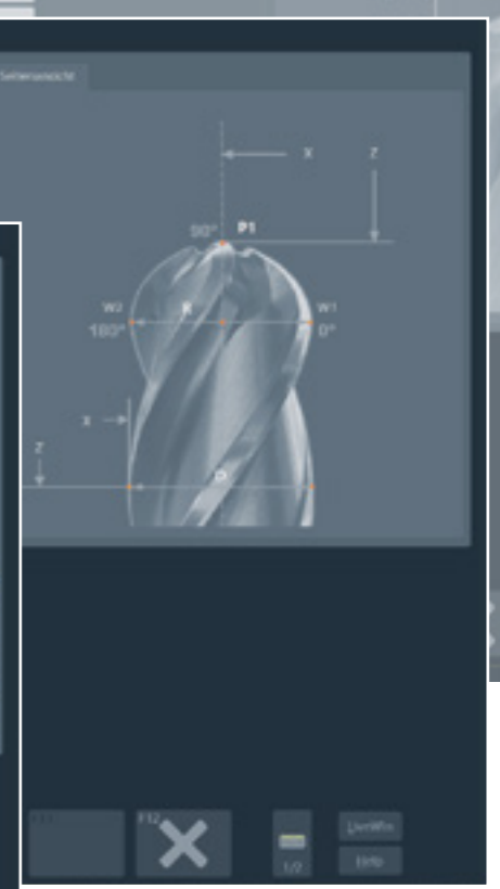
Analyse der Radiuskontur von Vollradiusfräsern in einstellbaren Winkelinkrementen. (Messprogramm 137)
