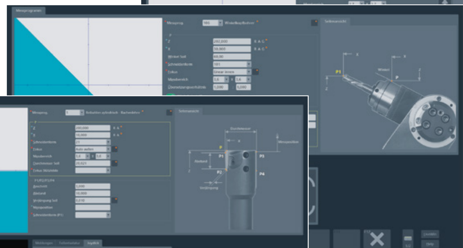
Einstellung und Vermessung von Bohrwerkzeugen in Winkelköpfen. (Messprogramm 106)
