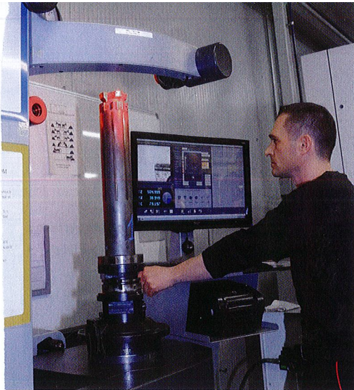
Das Venturion 600 wird zur Einstellung von Reibahlen und Fräsern aller Art eingesetzt
