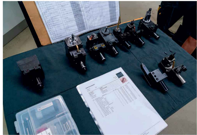
3 Eine der Herausforderungen in der Fertigung: die große Werkzeugvielfalt. SycoTec spannt sowohl mit statischen als auch mit unterschiedlichsten rotierenden Werkzeugen (© E. Zoller)
