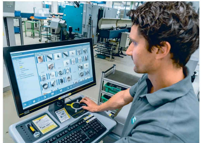
5 Die Messgeräte-Software »pilot« ist offen gegenüber sämtlichen Maschinensteuerungen und bietet zahlreiche Datenübertragungsmöglichkeiten (© E. Zoller)
