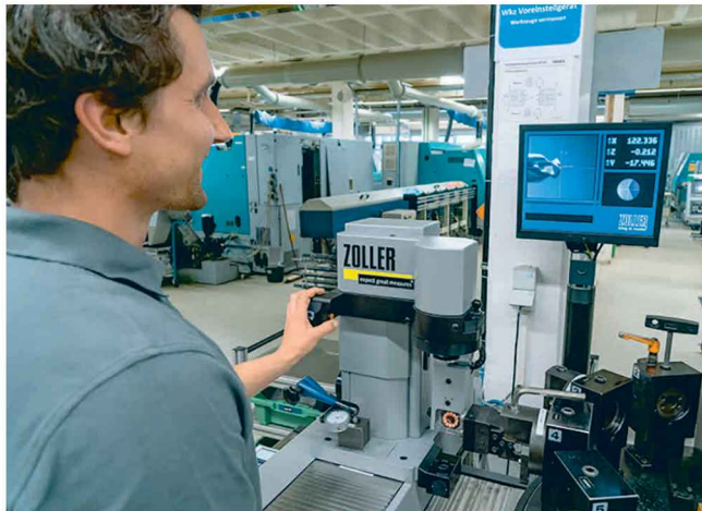
4 Die dritte, also die Y-Achse des Zoller-Messgeräts »hyperion« ermöglicht die komplette Vermessung von Drehwerkzeugen auf Mehrfachhaltern (© E. Zoller)
