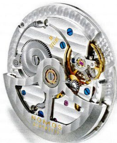
Uhrwerk Typ Epsilon: Dezentrale Sekunde; Sekundenstopp; Glashütter Dreiviertelplatine und Glashütter Gesperr; beidseitig aufziehender Rotor; TrioVis-Feinregulierung (reguliert in sechs Lagen); Unruhspirale aus Nivarox 1A; Incabloc-Stoßsicherung; temperaturgebläute Schrauben; Sperr- und Doppelrad mit Glashütter Sonnenschliff; rhodinierte Werkoberflächen mit Glashütter Streifenschliff und Nomos-Perlage
