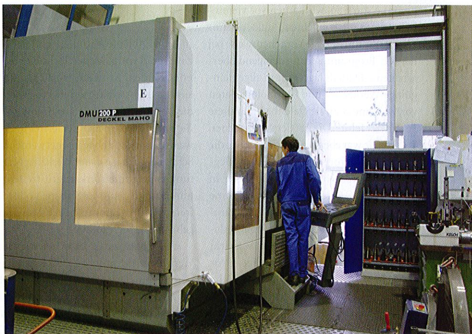
1 Mühlbauer Maschinenbau ordnet die Werkzeuge den Maschinen in drei Werkzeugkategorien zu. Kategorie eins ist auf der Maschine, Kategorie zwei lagert in einem Schrank an der Maschine. Kategorie drei enthält Sonderwerkzeuge
