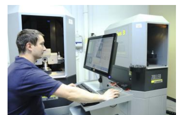
Uwe Schenn, Fertigungsmeister, bei der Werkzeugvermessung an der Universal-Messmaschine »genius«
