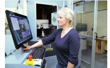
Marion Kießling, Qualitätssicherung, beim Starten des »roboSet« für die Endkontrolle der Werkzeuge vor der Auslieferung
